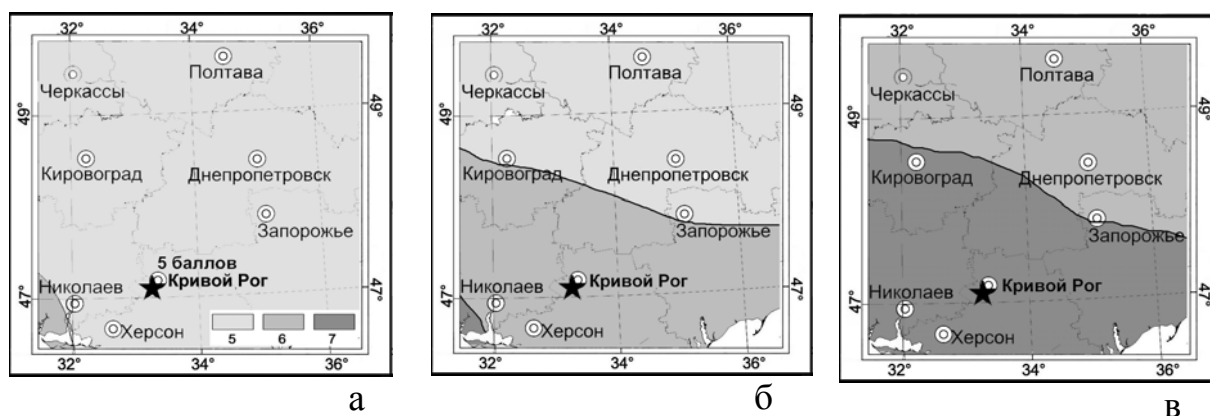
Рис. 1. Фрагменты карт долговременной сейсмической опасности Украины [2] для района Криворожского землетрясения 25 декабря 2007 г. с K_p=9.7 , MLH=3.1 , M_w=3.7 для периодов повторяемости 500 (а), 1000 (б) и 5000 лет (в) (звездочкой отмечено землетрясение с указанием интенсивности в эпицентре)
