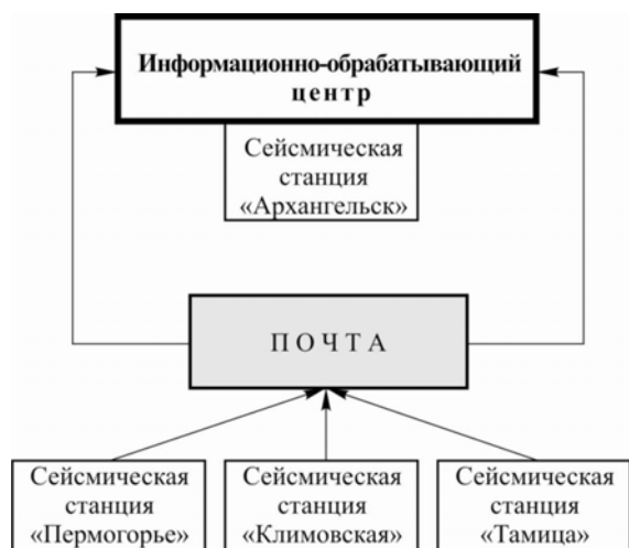
Рис. 4. Схема передачи данных с сейсмических станций в Центр обработки
