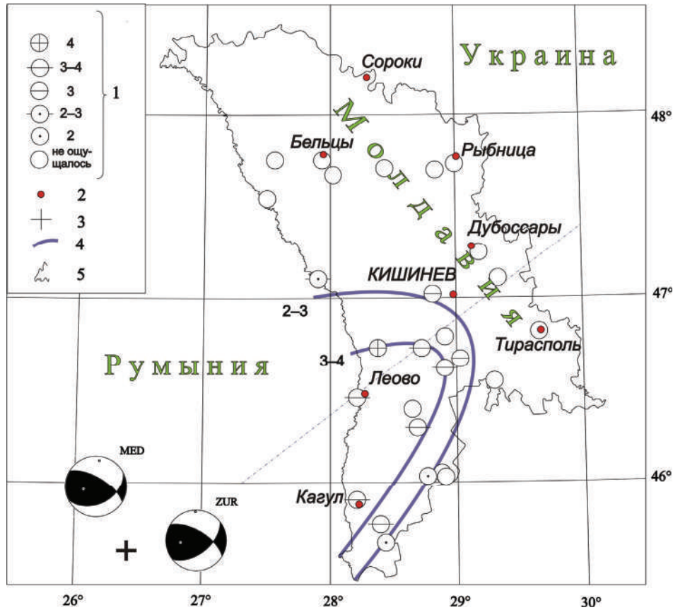
Рис. 3. Схема распределения интенсивности сотрясений при землетрясении 4 марта 2001 г. в 15 h 12 m с K_p=11.7 и h=151 км, а также стереограммы механизма его очага
