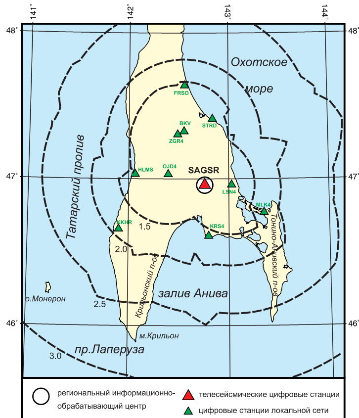
Рис. III.7. Сейсмические станции локальной сети на юге о. Сахалин в 2020 г.
