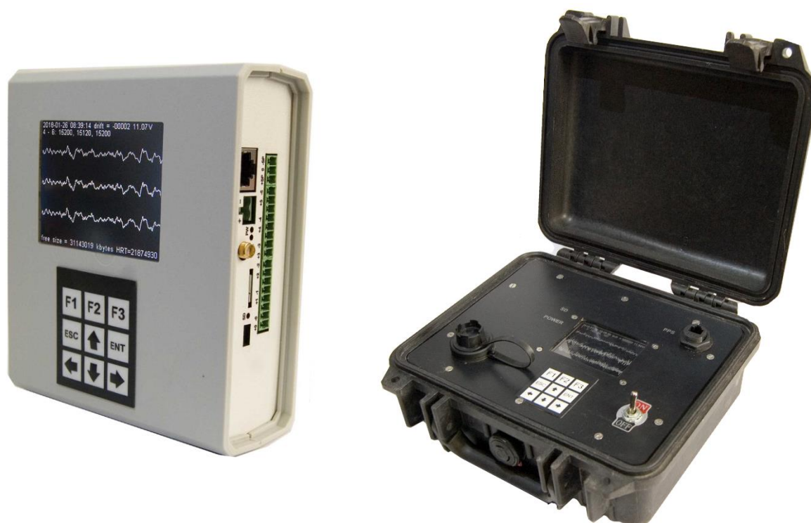
Сейсмический регистратор «Ермак-5.2» в стационарном и полевом исполнении
