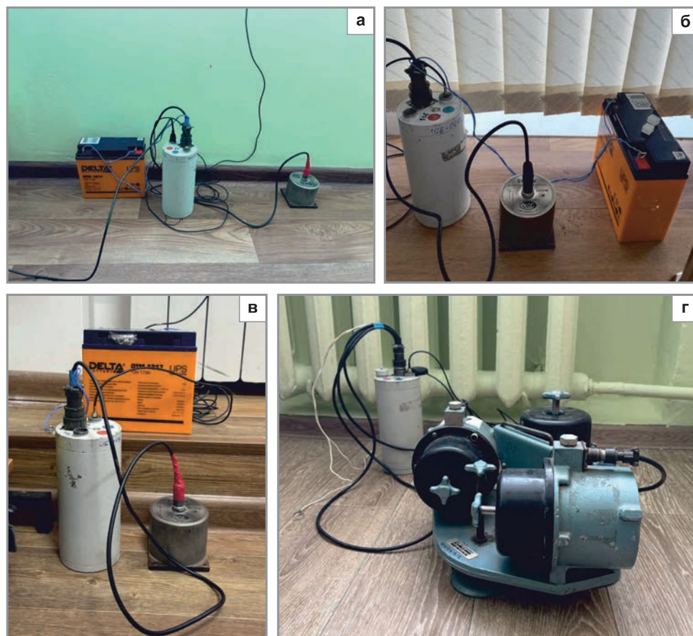
Рис. 2. Сейсмическая аппаратура, временно установленная в зданиях СОШ № 64 Иркутска: а – регистратор серии «Байкал-АСН» на 1 этаже нового корпуса; б – регистратор серии «Байкал-АСН» на 3 этаже нового корпуса; в – регистратор серии «Байкал-АСН» на 1 этаже старого корпуса; г – то же, на 3 этаже старого корпуса школы
