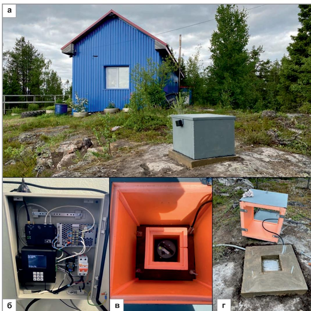
**Рис. 3.** Оборудование сейсмической станции «Умба»: а – расположение сейсмического датчика на территории метеорологической станции Мурманского УГМС; б – бокс с оборудованием сейсмостанции (регистратор, GSM-роутер, система питания); в – расположение датчика внутри термостатированного сейсмобиокса; г – подготовленное скальное основание для установки датчика
