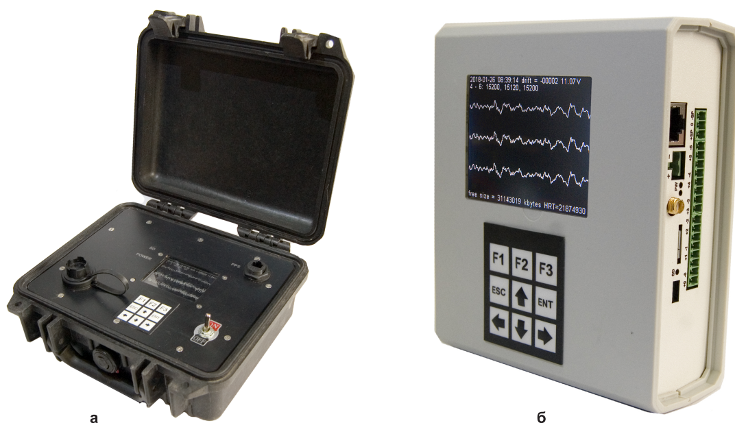
Рис. 3. Цифровой сейсмический регистратор «Ермак-5»: а – в исполнении «Поле»; б – в исполнении «Регион»
