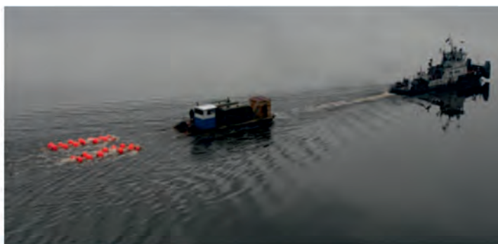
Регистрация с использованием донной сейсмической косы
